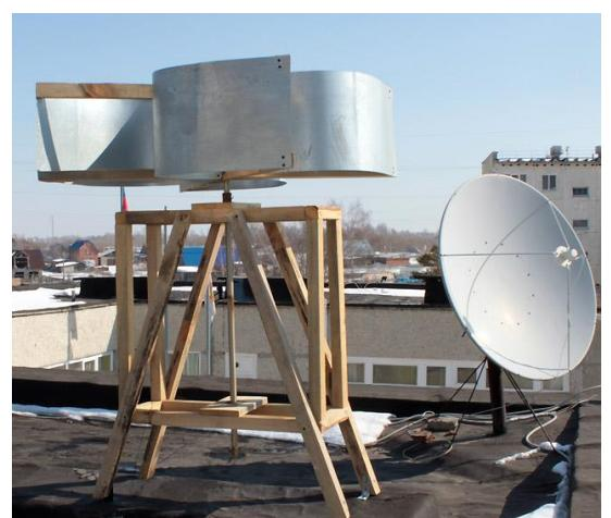
Размер лопасти 50 см x 100 см. из металлического листа 0,5 мм на деревянном каркасе.
